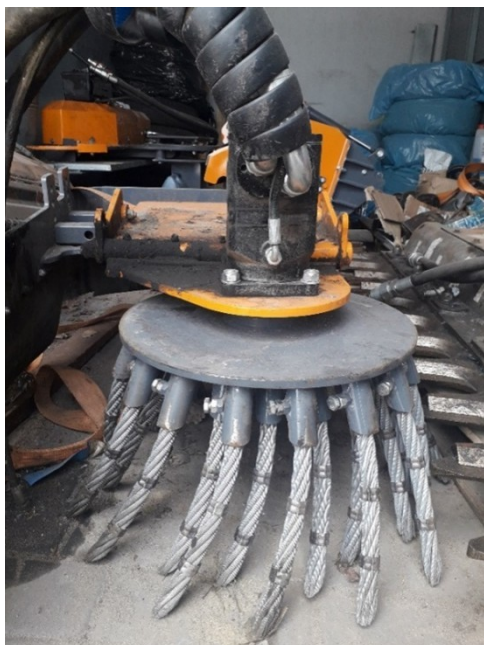
Obraz 29. Głowica odchwaszczarki do ciągnikowego ramienia wysięgnikowego hydraulicznego z zapasem szczotek
