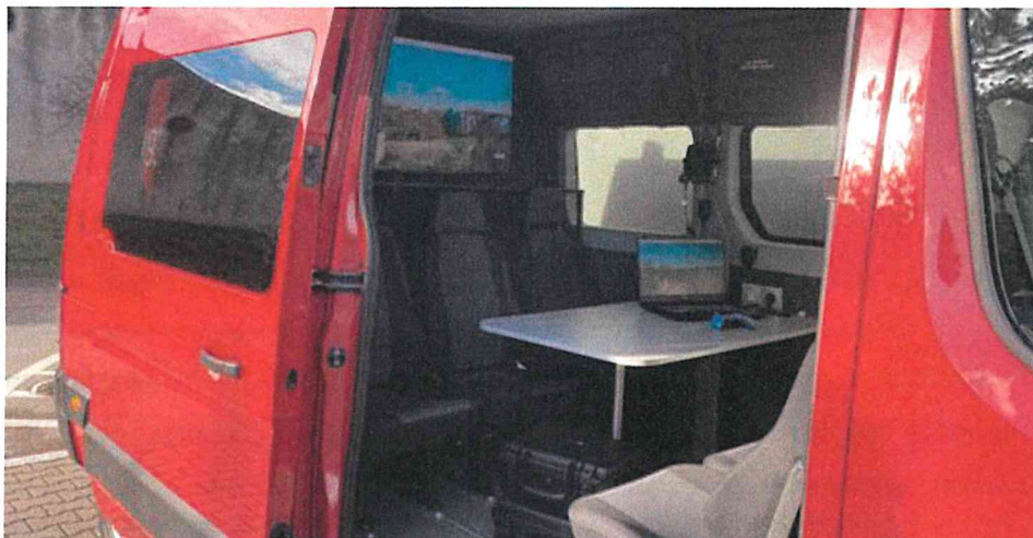
Zdjęcie 9. Wnętrze samochodu operacyjnego – na urządzeniach uruchomiony streaming obrazu z BSP
